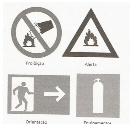
Figura 15: Sinalização de emergência
