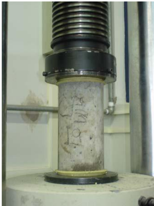
Figura 2 – Corpo-de-prova cilíndrico em ensaio para determinação da resistência à compressão do concreto
