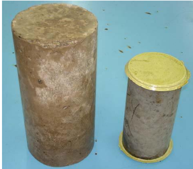
Figura 1- Corpos-de-prova cilíndricos 15 x 30 cm e 10 x 20 cm para determinação da resistência à compressão de concretos
