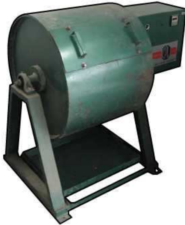
Figura 10: Equipamento de abrasão Los Angeles
