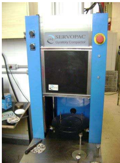
Figura 2: Exemplo de um Compactador giratório – Laboratório de Geotecnia da COOPE
