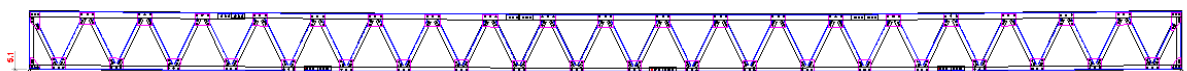
Figura 27: Deslocamentos dos nós viga treliçada TIPO D – Tesoura Warren (b) Resultado: Deslocamento máximo de 5,06 cm.
