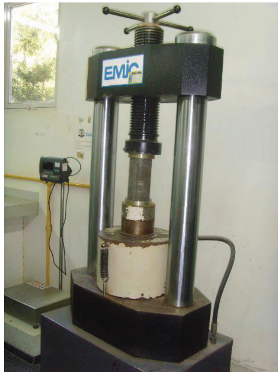
Figura 14: Ensaio de resistência a compressão
