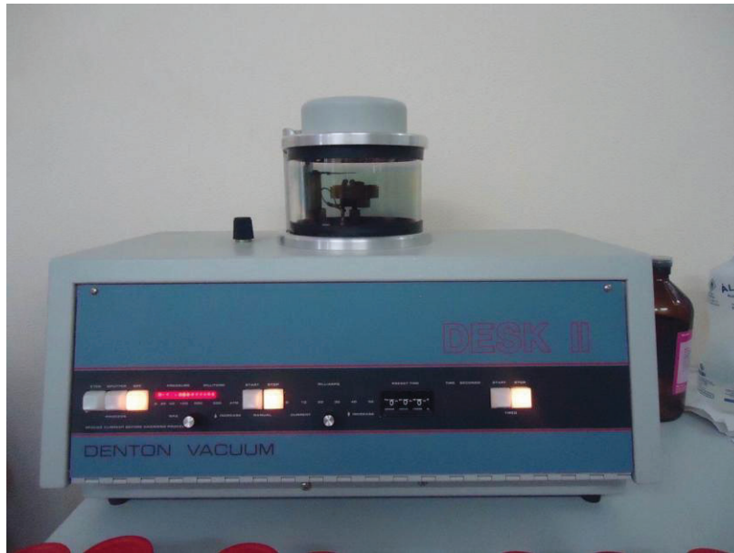
Figura 15: Amostras em recipiente à vácuo sendo pulverizadas com ouro
