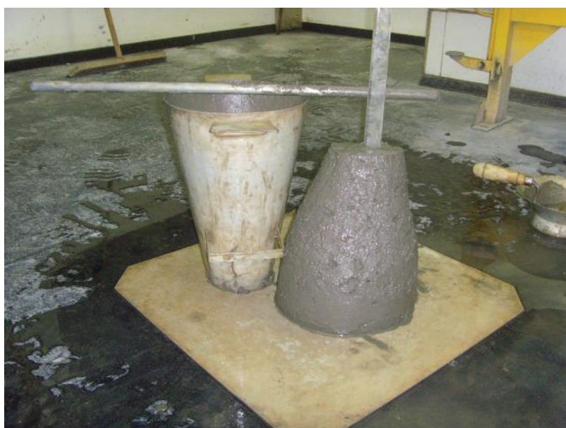
Figura 13: Slump flow test sendo executado
