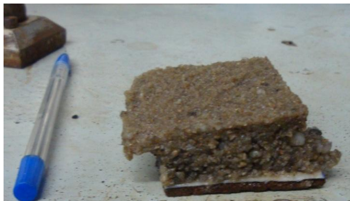
Figura 13: Solo após o ensaio de cisalhamento direto
