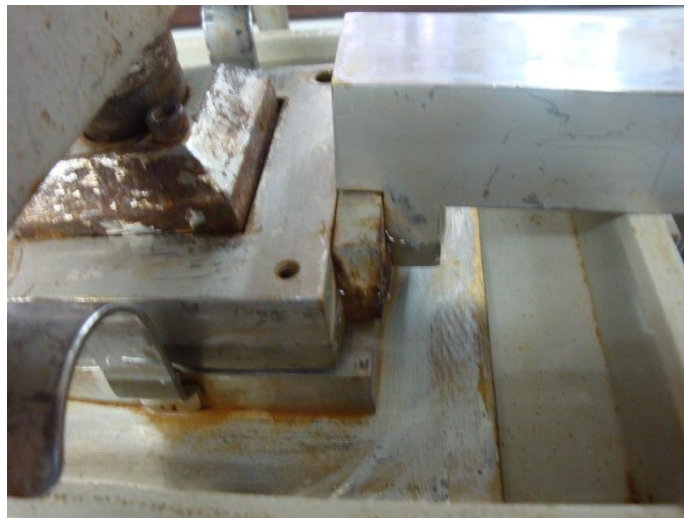
Figura 12: Esquema do ensaio de cisalhamento direto
