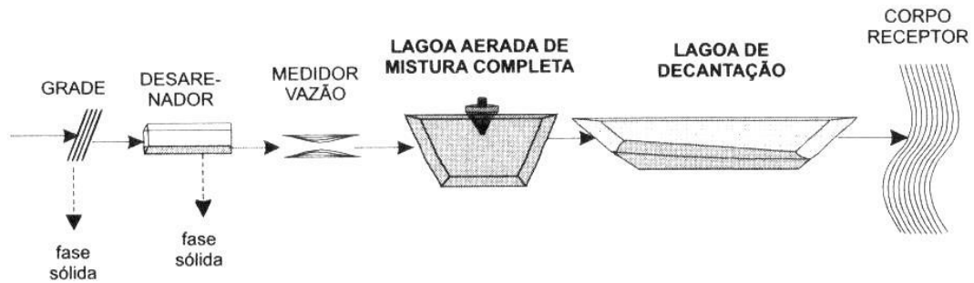
Figura 23: Fluxograma típico de um sistema de lagoas aeradas de mistura completa – lagoas de decantação
