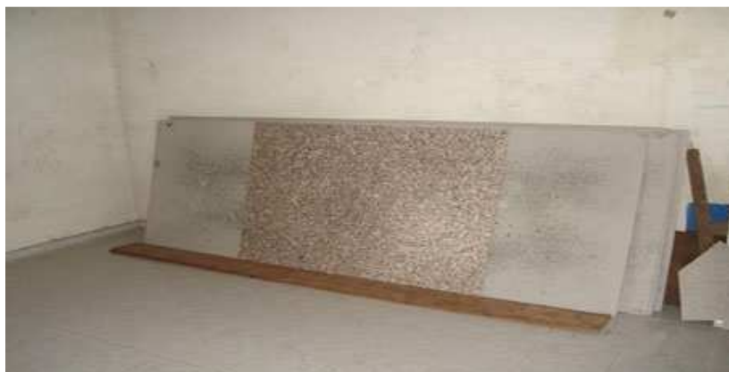
Fig. 11: Placa produzida com embalagens Tetra Pak Fonte: Engeplas, 2010.
