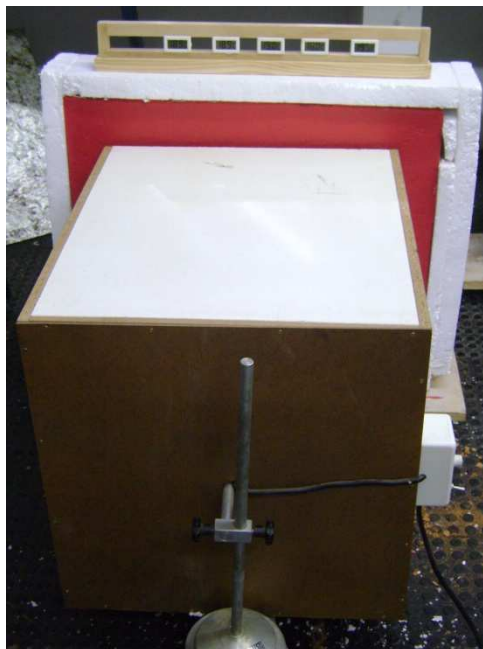
Fig. 28: Acoplamento da parede em estudo a câmara térmica.
