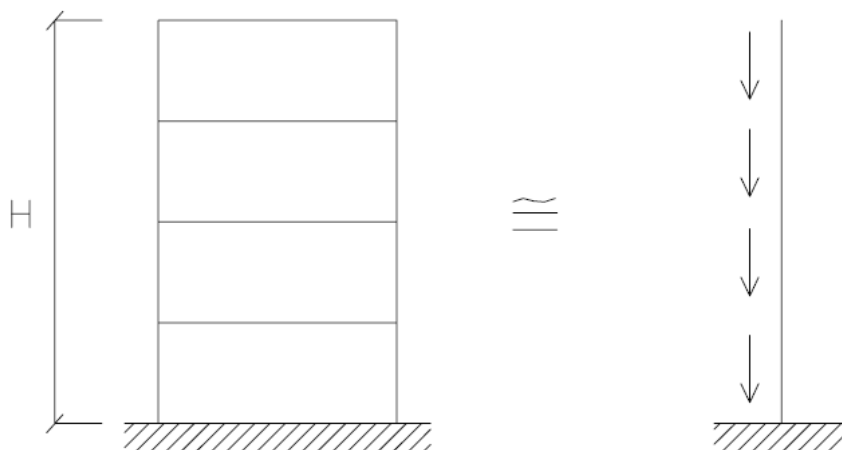
Figura 2 – Analogia entre a Estrutura e o Pilar em Balanço.
