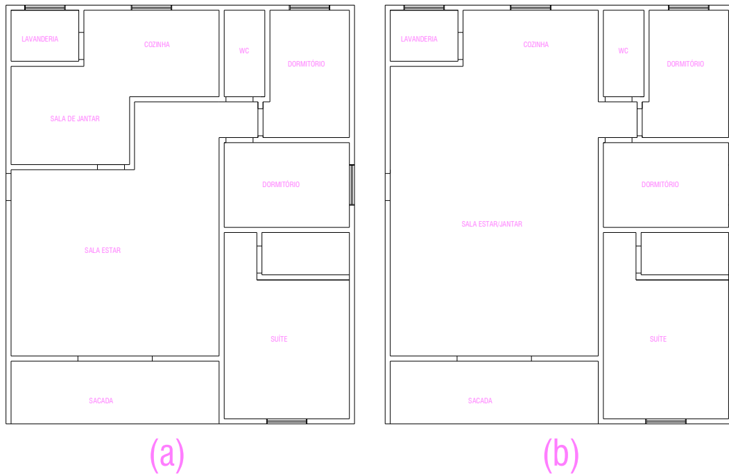
Figura 3 (a) Apartamento com paredes divisórias; (b) Apartamento com os ambientes integrados.
