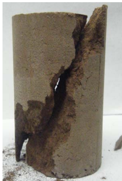
Figura 10: CP após ensaio de RCS
