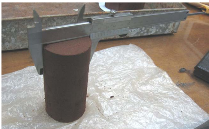
Figura 8: Medição de um CP com uso de paquímetro
