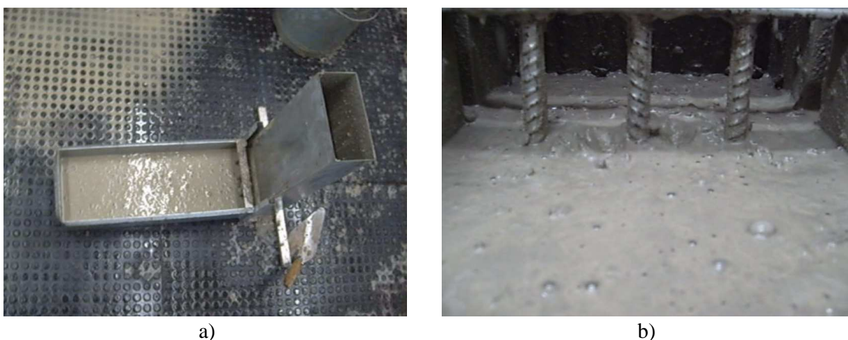
Figura 14: Escoamento total do concreto - a) Nivelamento total do concreto; b) Concreto nivelado entre as barras
