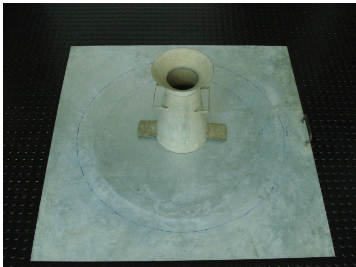
Figura 23: Base metálica implementada para utilização no Slump flow test
