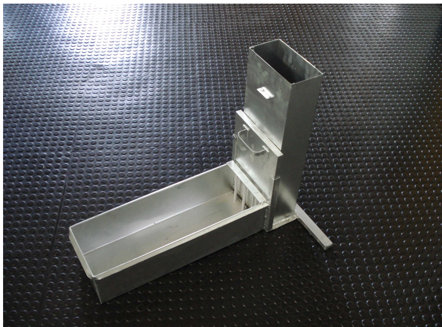
Figura 22: Caixa – L implementada
