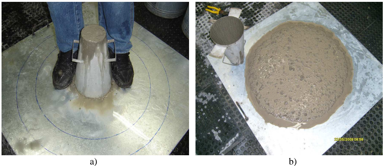
Figura 16: Slump flow test sendo executado – a) Cone de Abrams já preenchido sem compactação; b) Escoamento ocorrido após o içamento do cone
