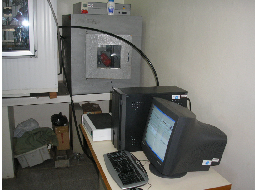
Figura 14 - Equipamento de módulo de resiliência ligado ao microcomputador
