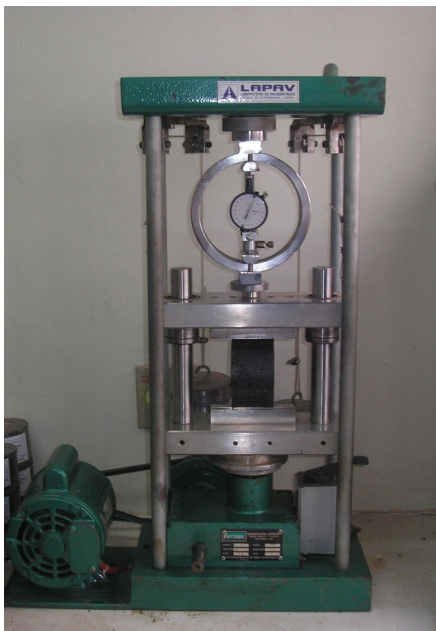
Figura 12 - Equipamento e estado de tensões gerado no ensaio brasileiro
