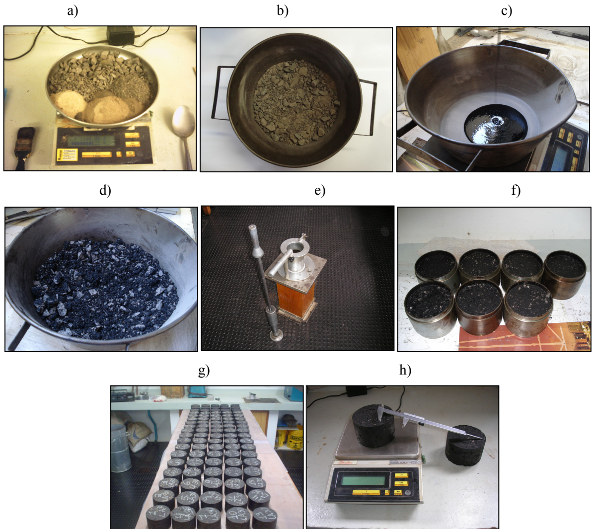
Figura 11 - Seqüência da dosagem; (a) Pesagem dos Agregados; (b) Agregados; (c) Ligante; (d) Mistura ligante/agregado; (e) Compactação da mistura; (f) Amostras Compactadas; (g) Amostras desmoldadas; (h) Pesagem e medição
