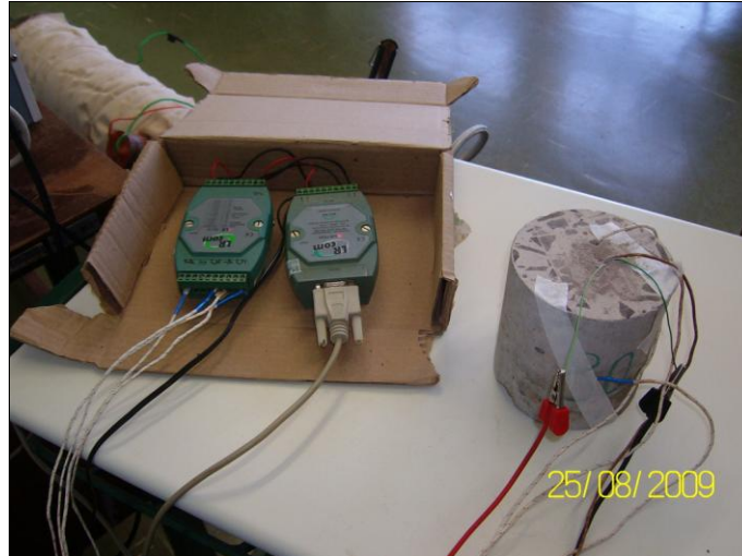
Figura 13: Sistemas de termopares instrumentado em CP.
