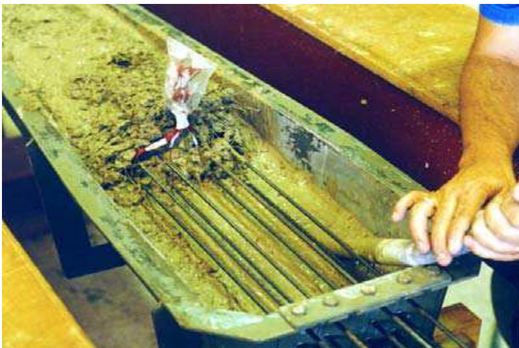
Figura 2 – Preenchimento de uma fôrma metálica com concreto aderente à armadura.
