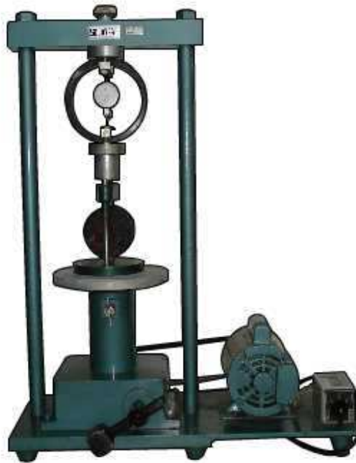
Figura 5 : Exemplo de equipamento para ensaio de Rt.
