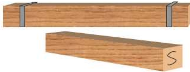
Figura 24: Artíficos para evitar o fendilhamento Fonte: PORTO, 2004
