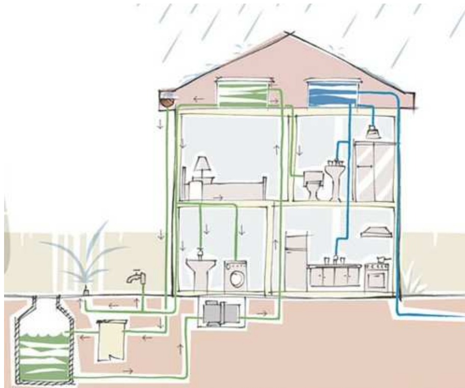
Figura 28: Captação de água da chuva
