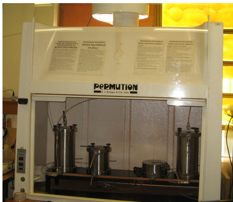
Figura 9 – Vista geral dos permeômetros instalados em uma capela de exaustão de gases
