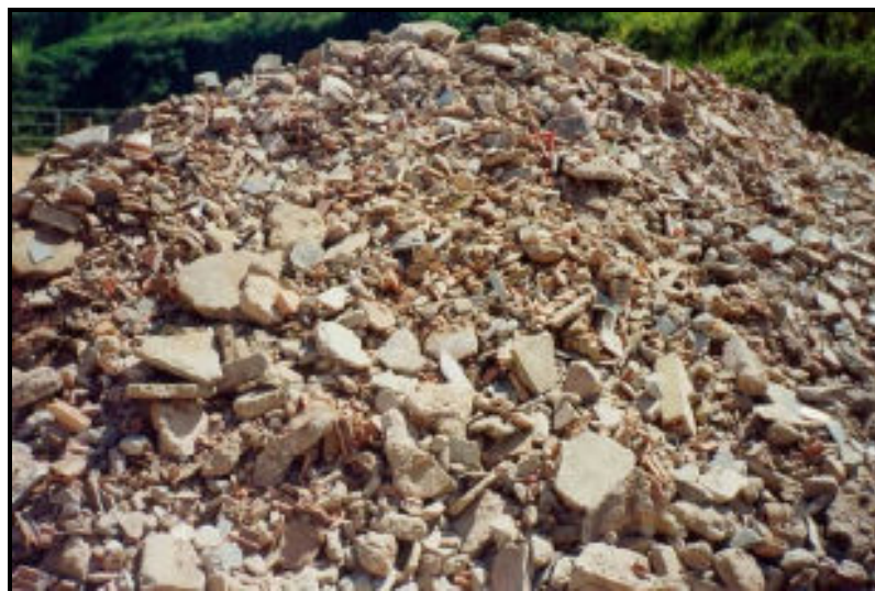
Figura 6: RCD em obra.
