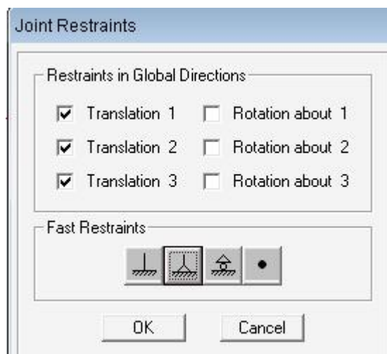
Figura 4.13 – Detalhe do menu de definição de apoios.
