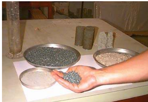
Figura 5: O plástico usado como agregado alternativo
