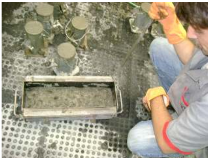
Figura 14: Moldagem do corpo de prova prismáticos
