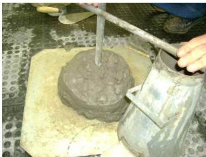
Figura 13: Medição abatimento do tronco de cone
