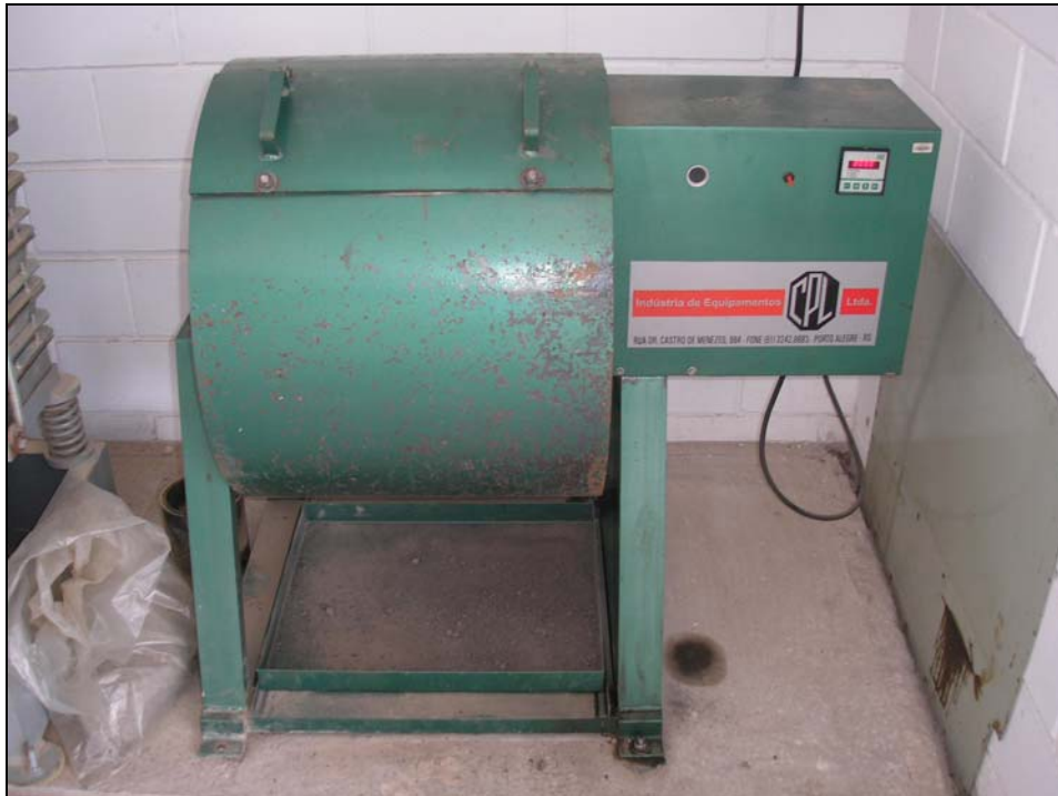
Figura 18: Execução do ensaio de desgaste Cantabro
