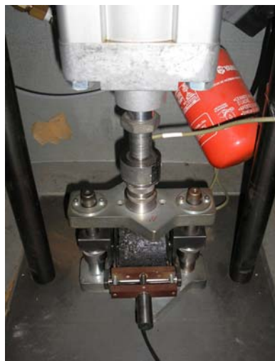
Figura 15: Equipamento de módulo de resiliência da UFRGS
