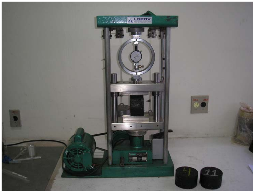
Figura 12: Equipamento de ensaio de compressão diametral
