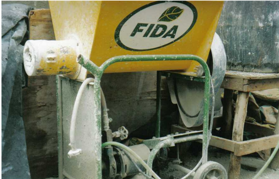
Figura 16: Argamassadeira utilizada pela equipe de obra
