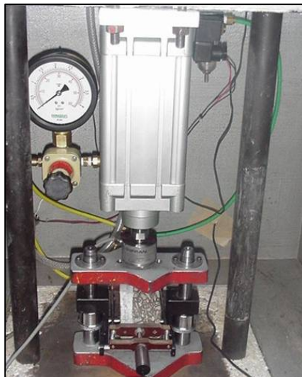
Figura 11: Vista interna do equipamento de módulo de resiliência
