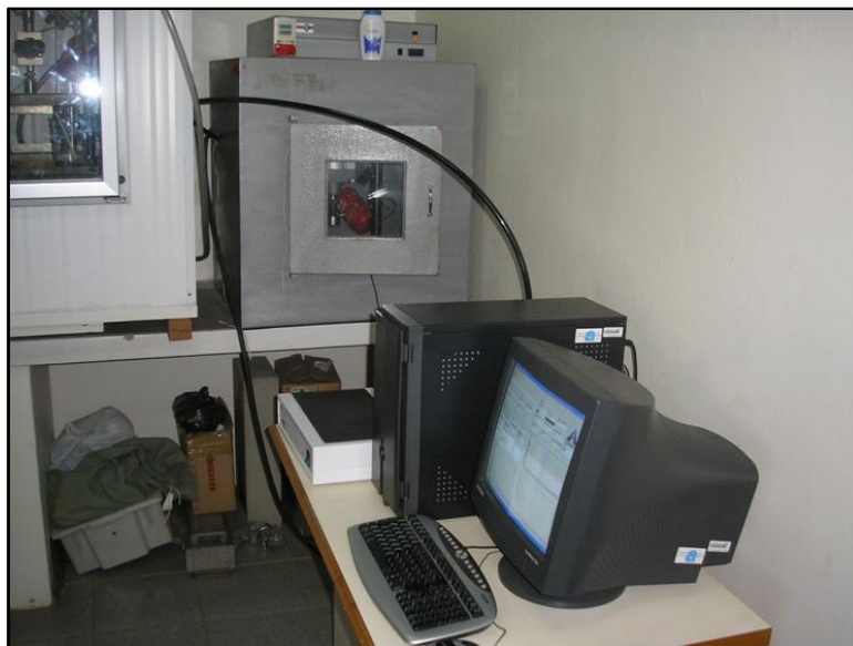
Figura 10: Equipamento de módulo de resiliência ligado a um microcomputador
