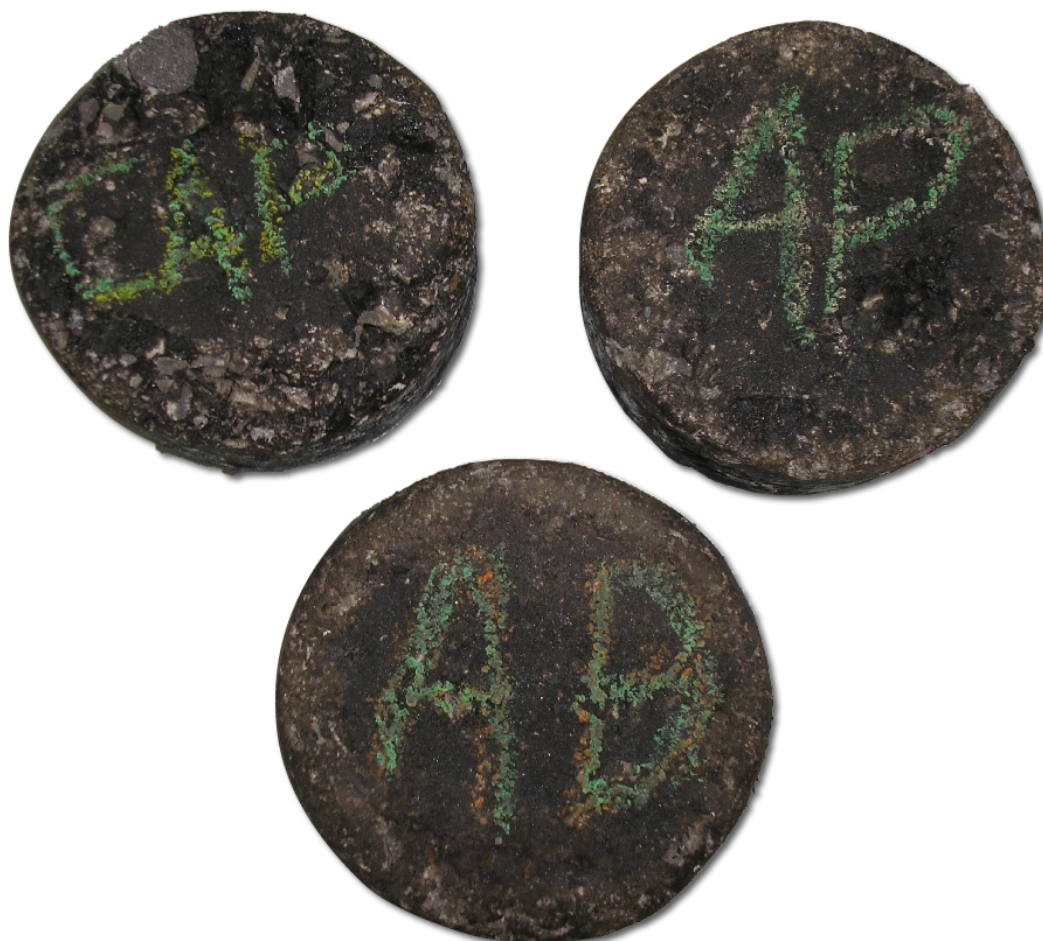
Figura 14: Aspecto dos corpos-de-prova após o ensaio de desgaste Cantabro
