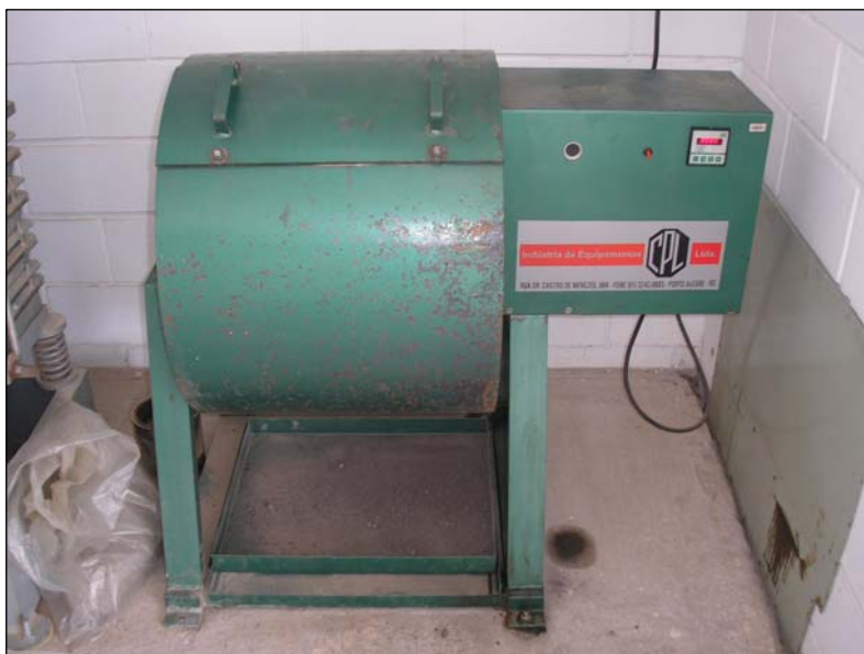
Figura 13: Execução do ensaio de desgaste Cantabro
