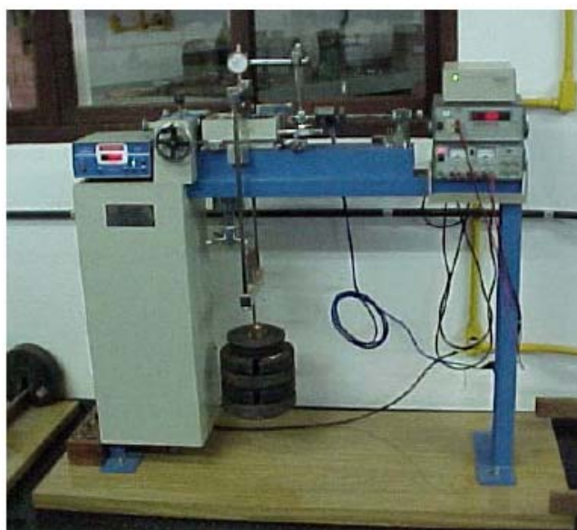
Figura 19: Equipamento de cisalhamento direto Fonte: Bonafé (2004)
