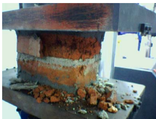
Figura 11: Rompimento dos Prismas
