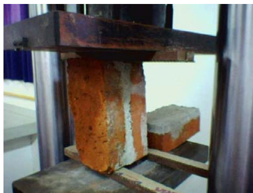
Figura 9: Rompimento da Tripletta
