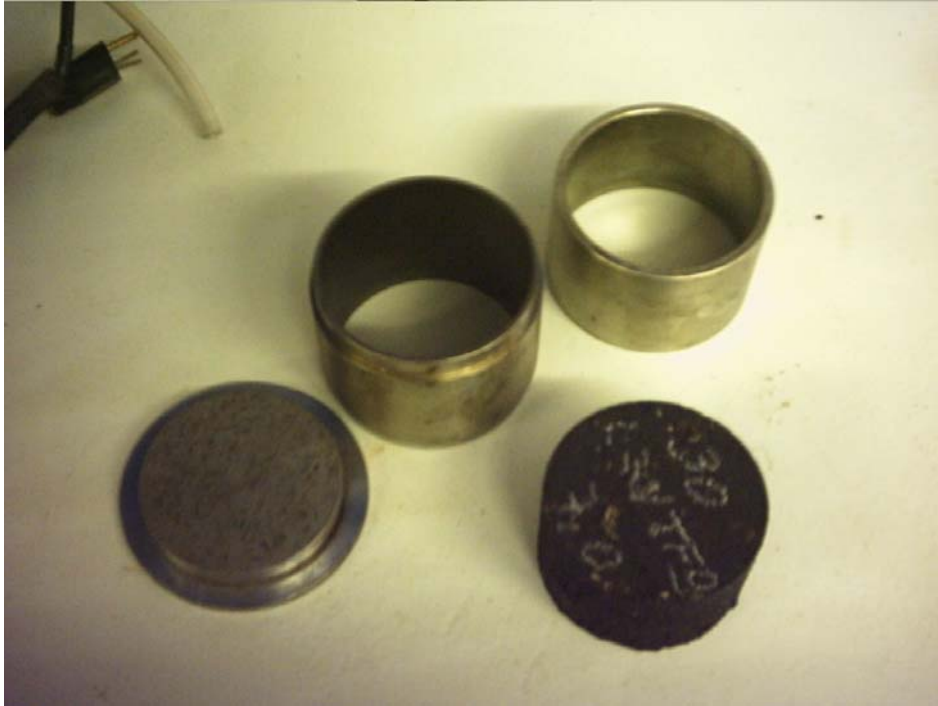
Figura 3.8: Extração dos corpos-de-prova dos moldes metálicos
