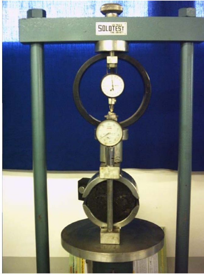
Figura 3.10: Rompimento dos corpos-de-prova em prensa Marshall.
