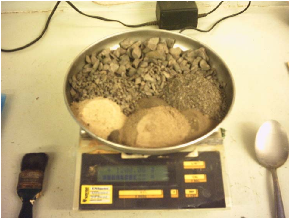
Figura 3.6: Separação e pesagem dos agregados
