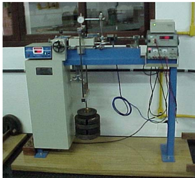
Figura 32: Equipamento de cisalhamento direto Fonte: Bonafê (2004)
