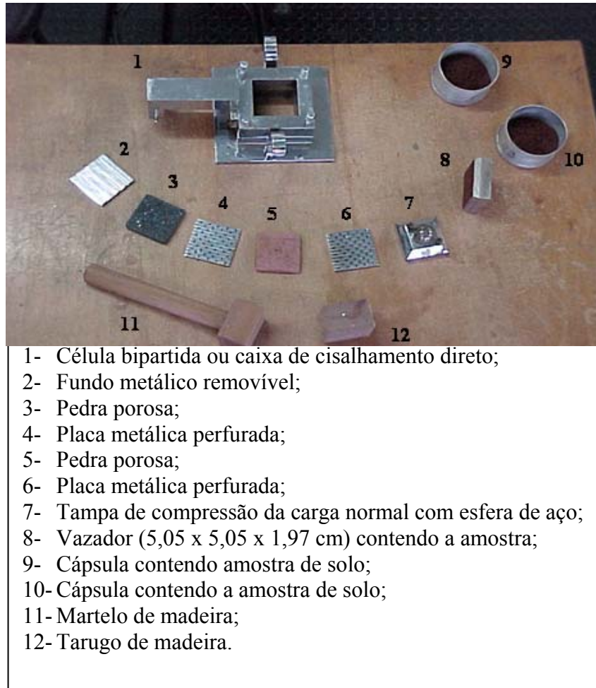
Figura 31: Acessórios do equipamento de cisalhamento direto Fonte: Bonafê (2004)
