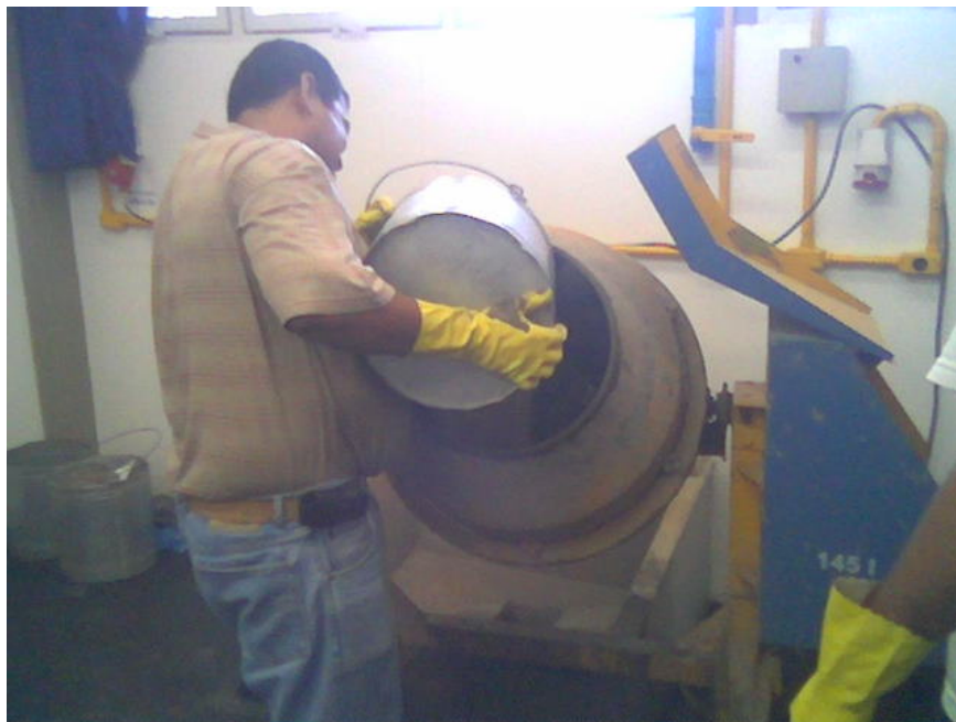
Figura 2 – Lançamento dos materiais na betoneira
