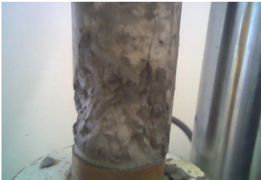
Figura 6 – Rompimento do corpo-de-prova (resistência à compressão aos 28 dias).
