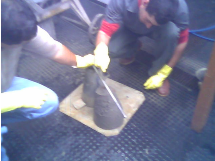
Figura 5 – Determinação da consistência da mistura inicial (slump test)
