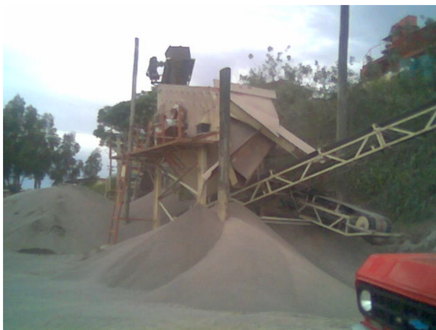
Figura 1 - Britador que produz a areia artificial
