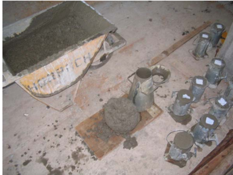
Figura 2 – Escolha do carrinho para a amostra e ensaio de abatimento pelo tronco de cone.
