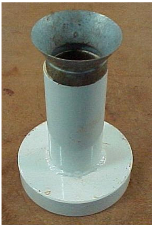
Figura 10: a) Molde para preparação de amostra para ensaio de compressão simples b) Prensa para romper corpos-de-prova de Compressão Simples
