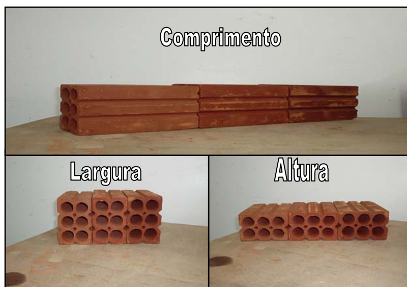
Figura 6 - Verificações dimensionais dos blocos de 6 furos
