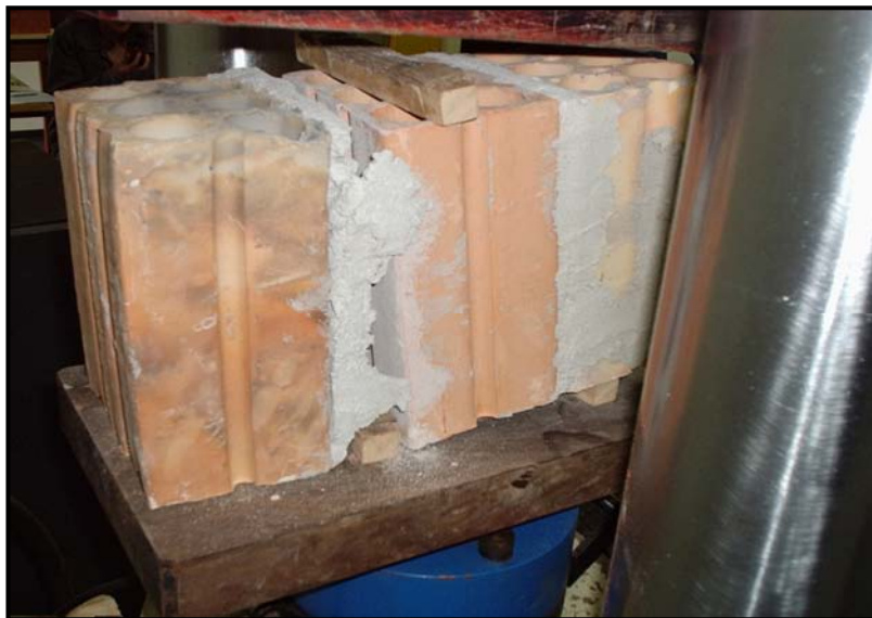
Figura 16 – Detalhe de aderência por cisalhamento dos blocos de 6 furos
