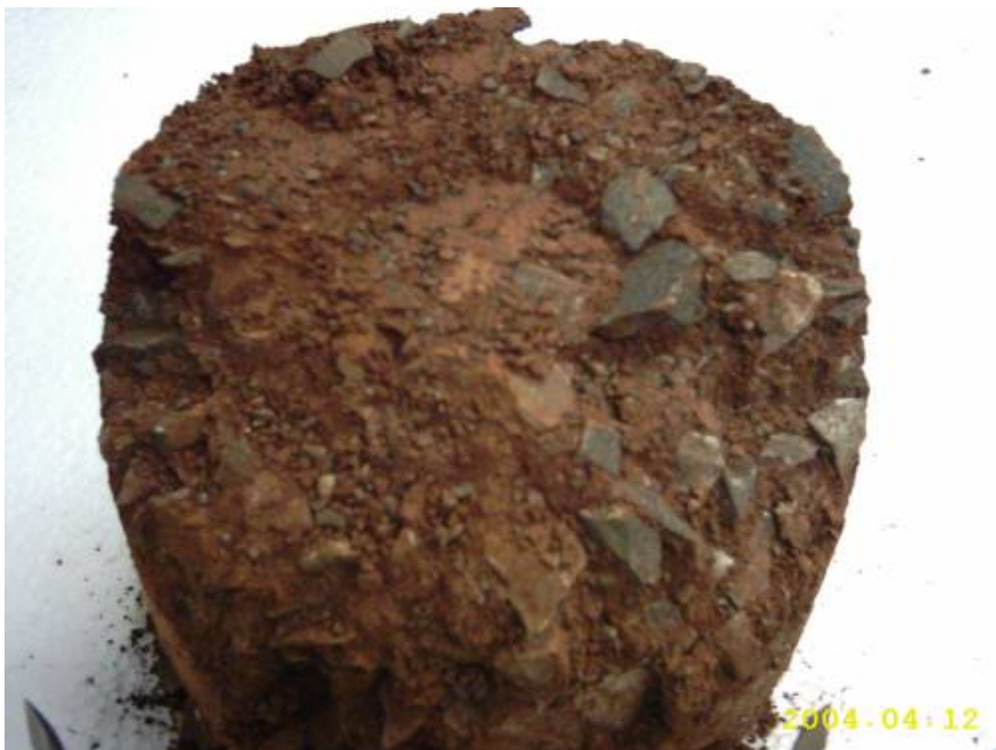
Figura 12 – Organização dos grãos na amostra com 30% de solo e 70% de agregado
