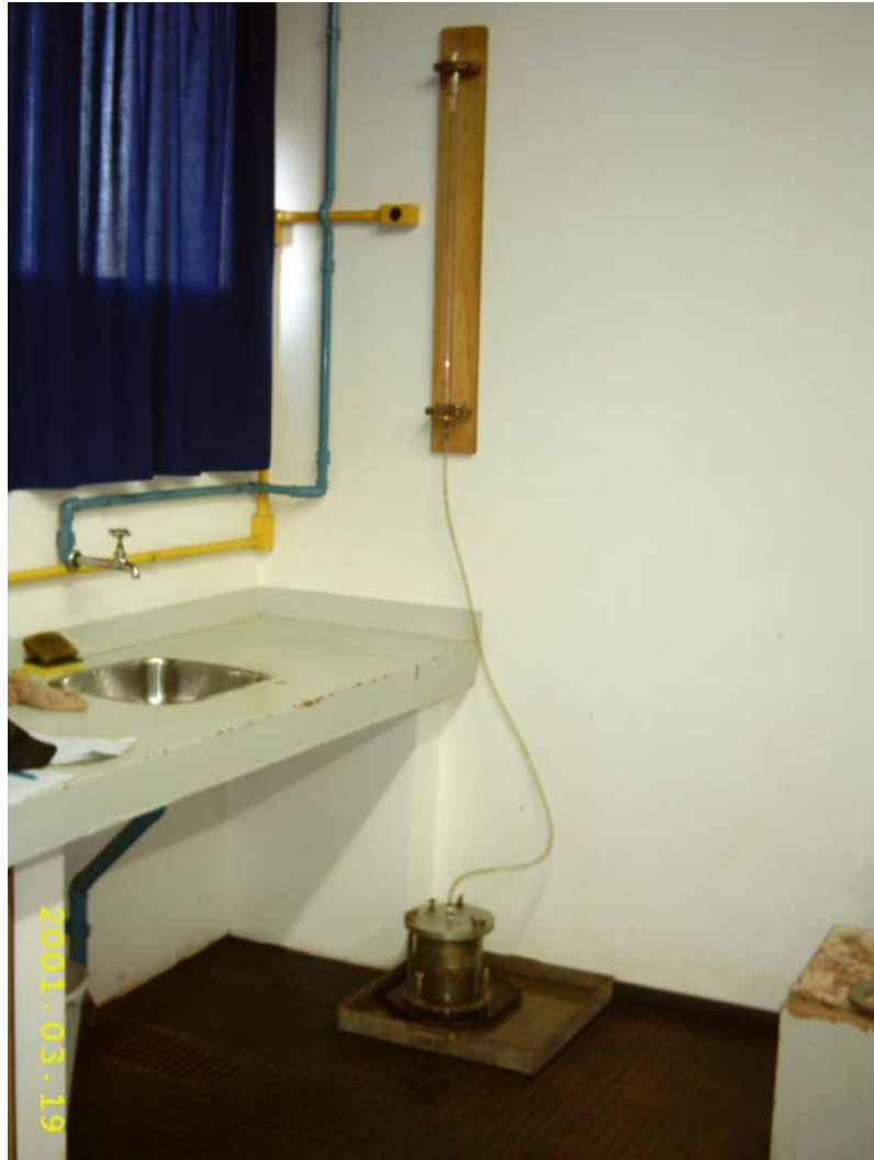
Figura 11 – Aplicação de água na coluna.
