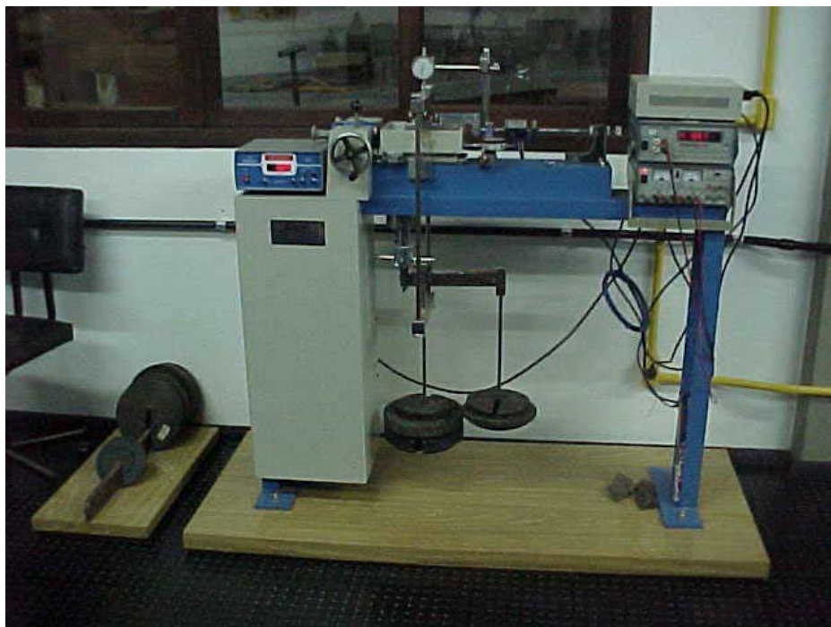
Figura 17 - Equipamento para cisalhamento direto em solos
