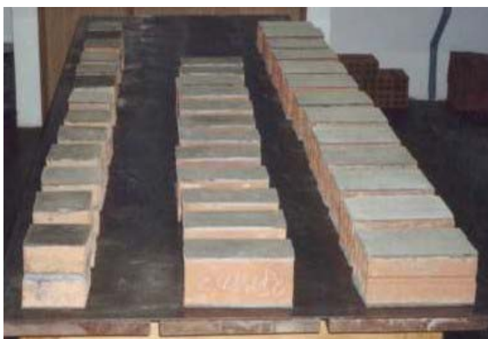
Figura 5 – Capeamento de tijolos maciços e blocos de vedação
