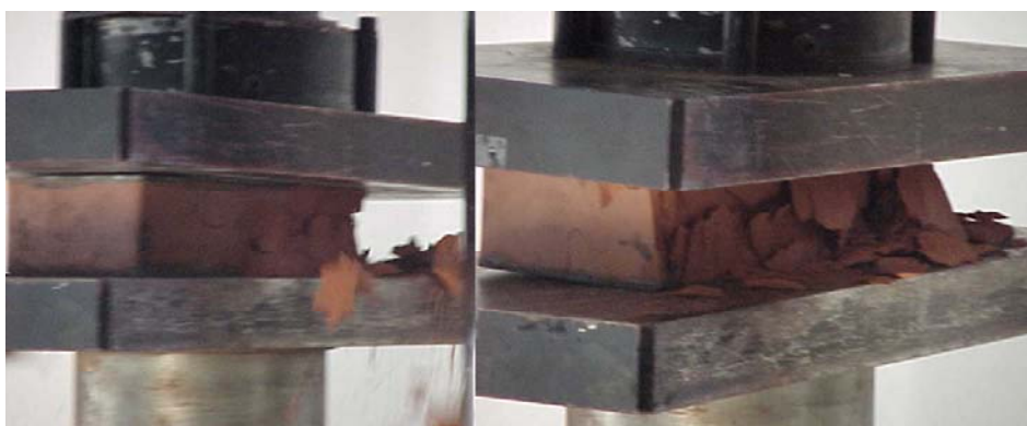
Figura 7 – Detalhe de ruptura de tijolos 21 furos
