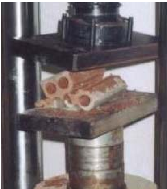
Figura 9 – Detalhe de ruptura de bloco de vedação
