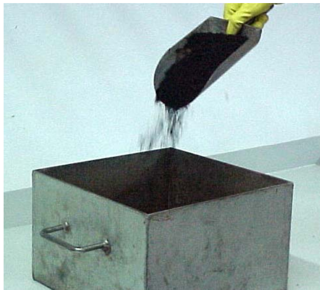
FIGURA 7 – Ensaio de massa unitária solta da borracha
