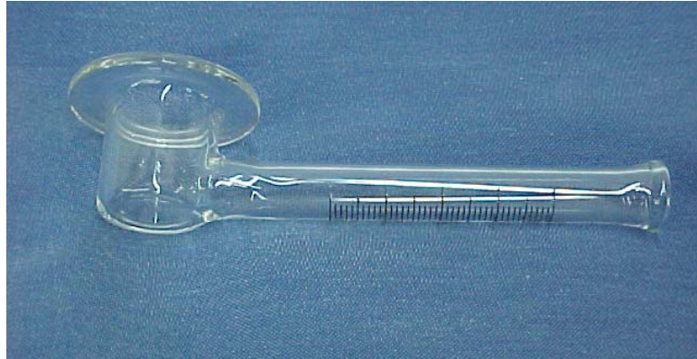
FIGURA 10 – Equipamento para ensaio de permeabilidade “cachimbo”
