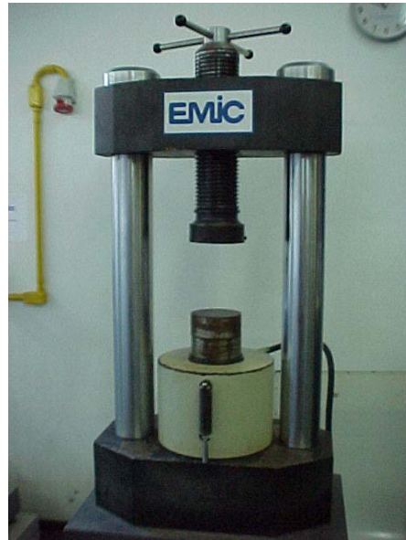
FIGURA 8 – Equipamento para ensaio de compressão axial
