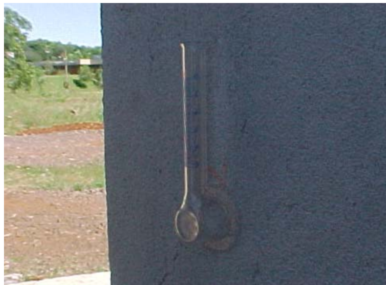
FIGURA 15 – Equipamento “cachimbo” fixado
