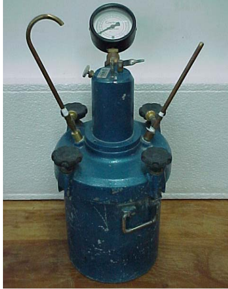
FIGURA 6 – Equipamento para ensaio de ar incorporado
