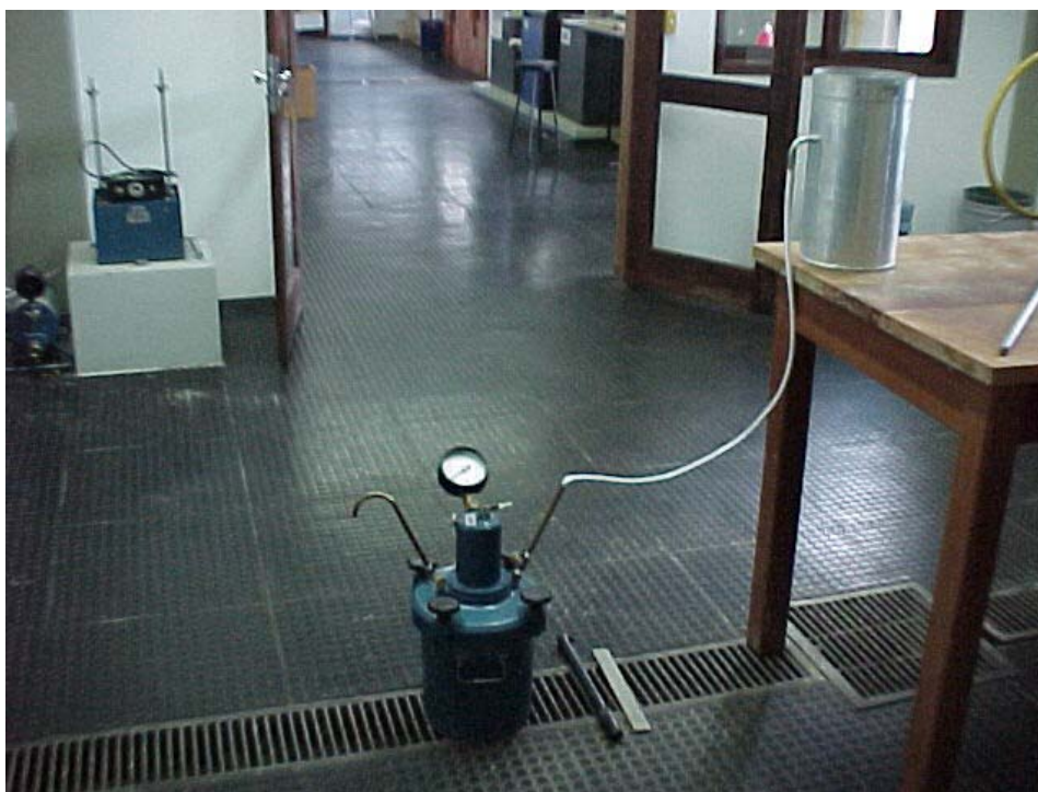
Figura 35 – Laboratório de concreto – Ar incorporado – LEC/UNIJUÍ
