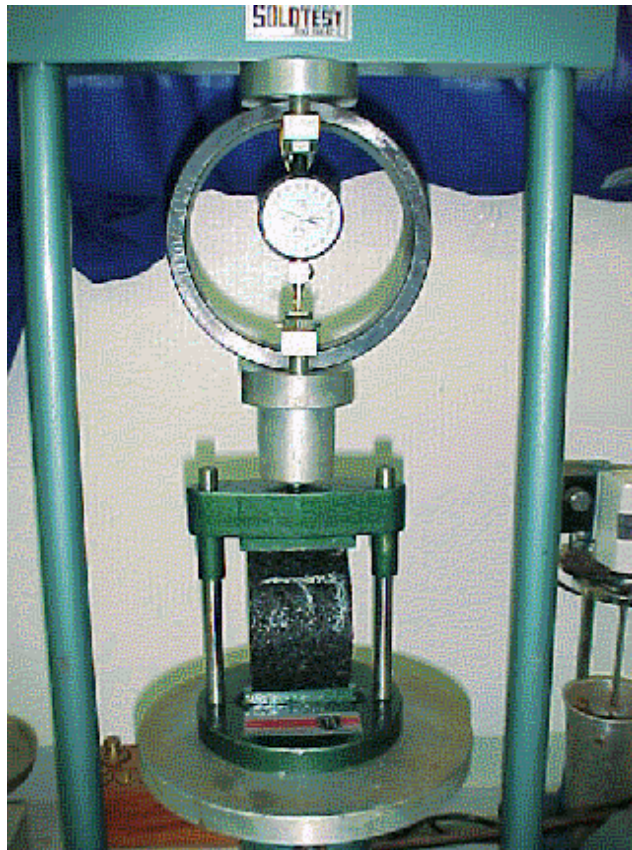
Figura 3.5: Prensa para rompimento dos corpos-de-prova à tração do LEC
