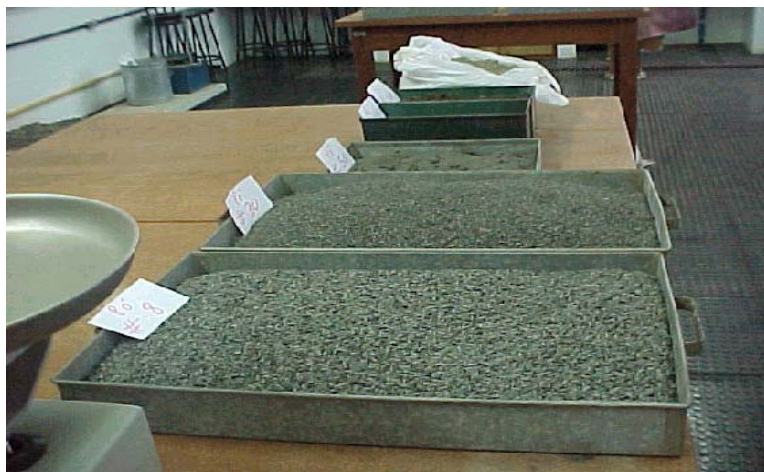
Figura 3.4: Agregados utilizados no estudo, separados por peneira
