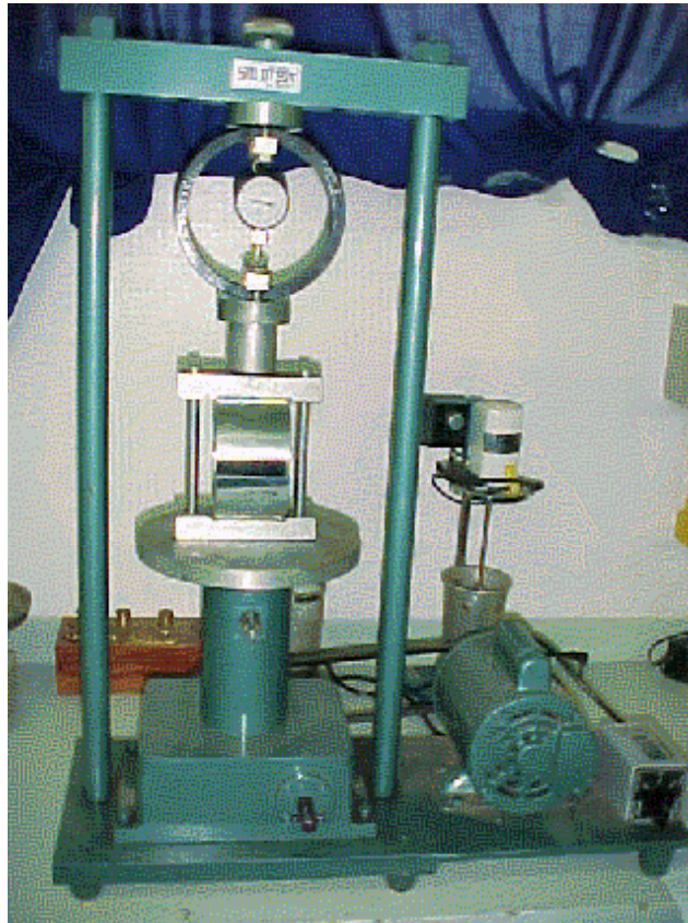
Figura 3.3: Prensa para rompimento dos corpos-de-prova Marshall do LEC – Laboratório de Engenharia Civil
