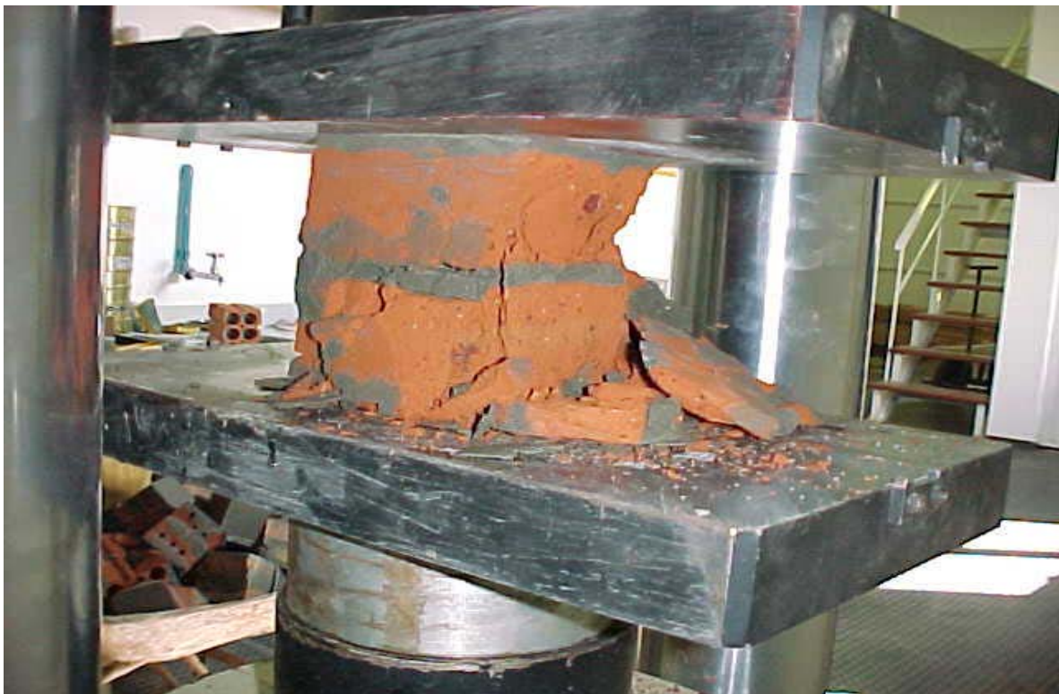
Figura 7 – Ensaio de resistência à compressão do tijolo.
