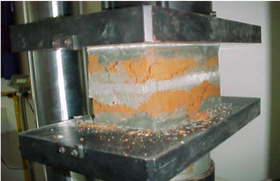
Figura 9 – Ensaio de resistência à compressão do prisma (maciço).
