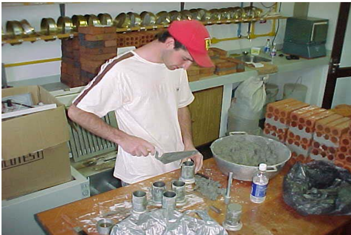
Figura 4 – Moldagem do corpo de prova cilíndrico
