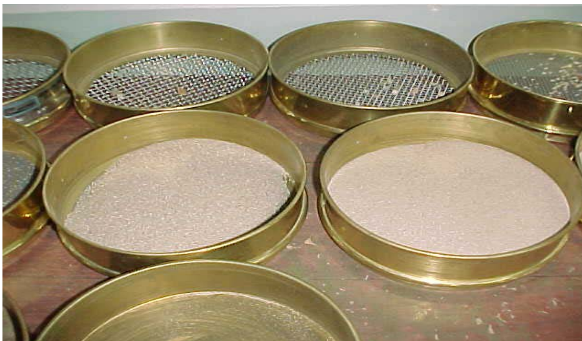
Figura 5 – Ensaio de caracterização da areia
