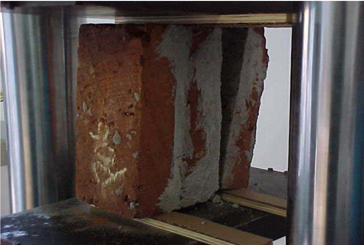
Figura 12 – Teste de aderência em prismas de tijolos
