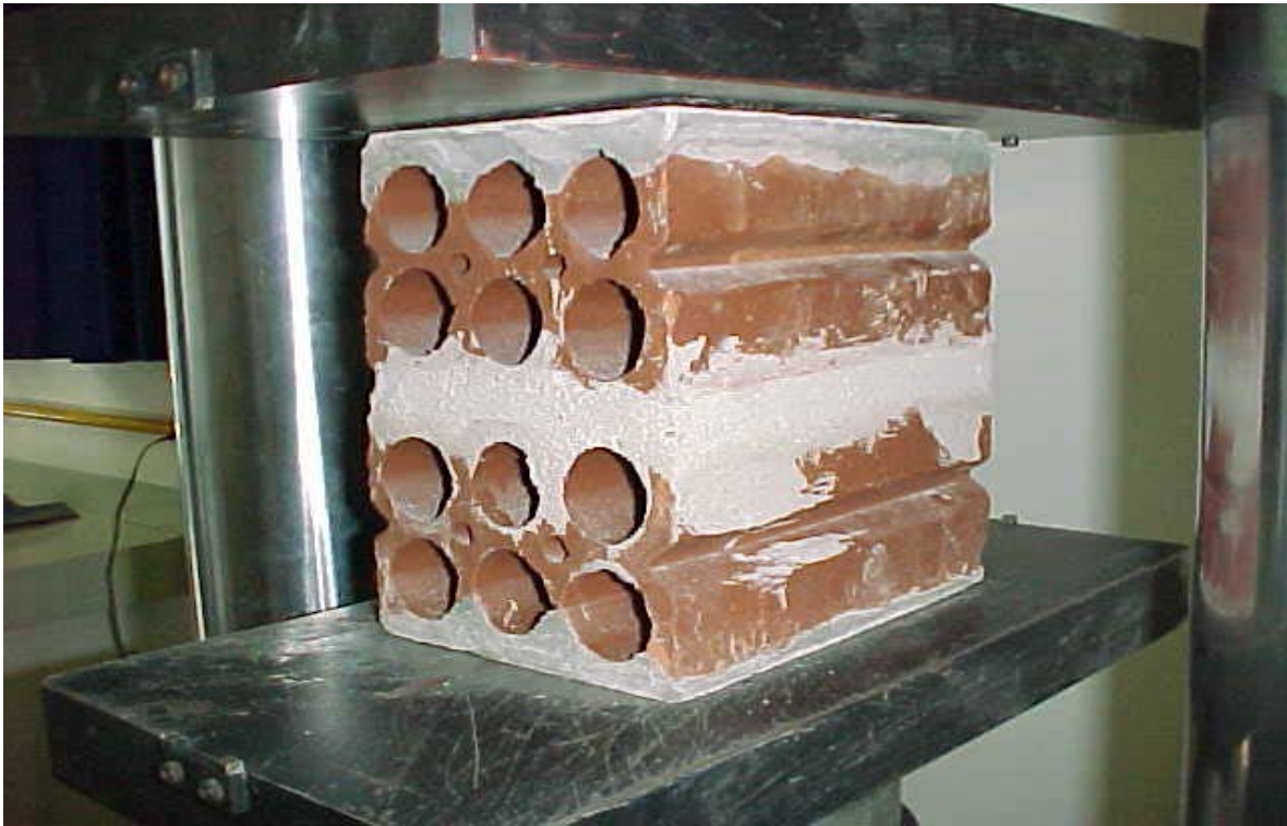
Figura 8 – Ensaio de resistência à compressão do prisma (bloco).
