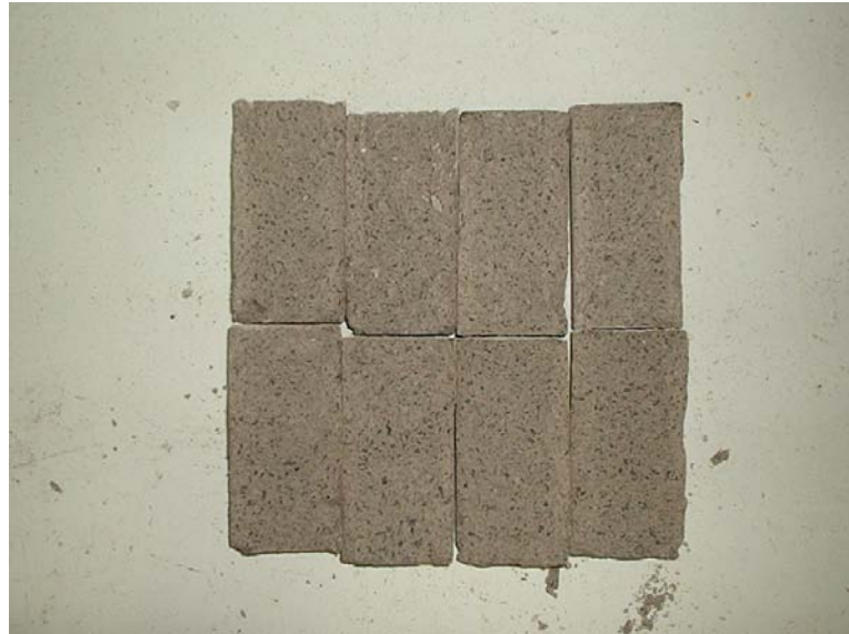
Figura 13 - Argamassa Rompidas à Tração
