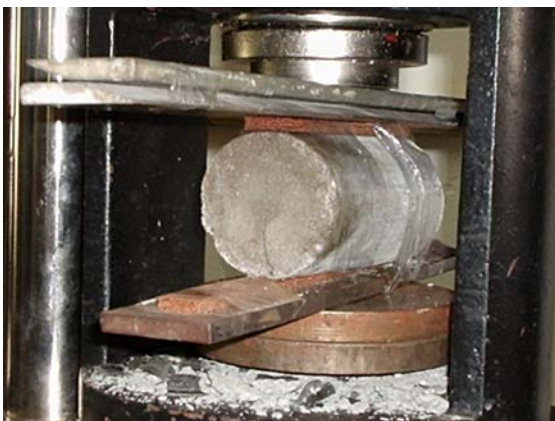
Figura 11 – CP de Argamassa à Tração
