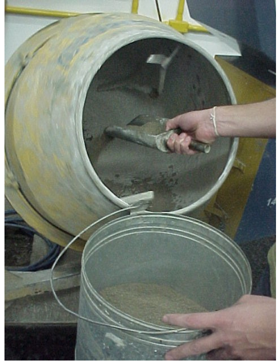
Figura 5 - Colocação da Areia Artificial na betoneira
