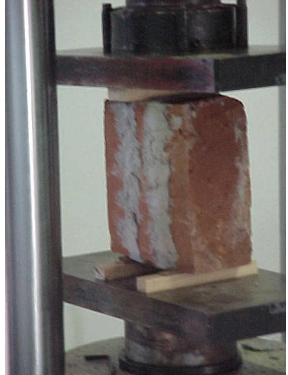
Figura 15 – Tripleta ao Cisalhamento
