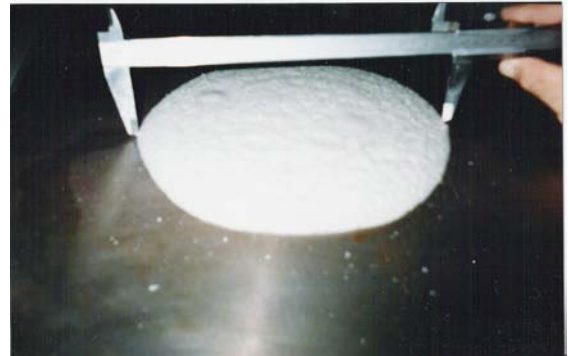
Figura 7 – Medida da Consistência
