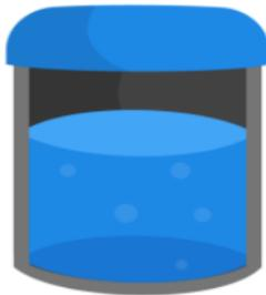
A água que está armazenada no tanque recebe a adição de um sal chamado de sulfato de alumínio ou sulfato férrico. Esses compostos formam uma substância gelatinosa que favorece a formação de flocos (junção das impurezas na substância gelatinosa).
